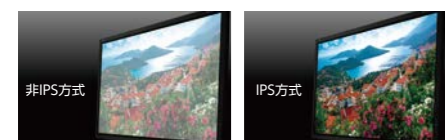
非IPS方式 全体が白く、彩度とコントラストが低下 IPS方式 正面から見た画像とほぼ同じ色彩で見える
