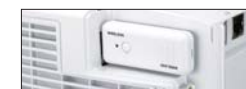
無線LANユニット(オプション) (USBポートカバーを外した状態)
